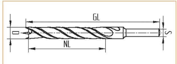
besonders geeignet für präzise Bohrungen in Weich- und Hartholz auf Handbohrmaschinen etc.
