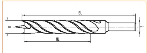
besonders geeignet für präzise Schrägbohrungen (Staketenlöcher) in Weich- und Hartholz im Treppenbau etc. auf Staketenloch-Vorrichtungen z. B. Bohrfix • Bohrluchs
