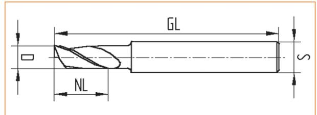
zur Bearbeitung von Stahlprofilen auf Kopierfräsen und Bearbeitungszentren z. B. AFS-Schirmer • elumatec
