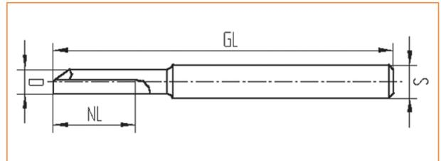
zum Fräsen von Profilen aus Aluminium, Kunststoff etc. auf Kopierfräsen, Wasserschlitzzfräsen und Bearbeitungszentren z. B. AFS-Schirmer • elumatec • Haffner • Rapid • Rotox • Striffler • Wegoma
