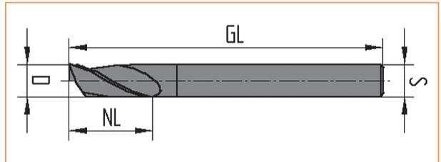
zum Fräsen und Bohren von Profilen aus Aluminium, Kunststoff etc. auf allen Bearbeitungszentren z. B. AFS-Schirmer • elumatec • Haffner • Rapid • Rotox • Schüco • Striffler • Wegoma
