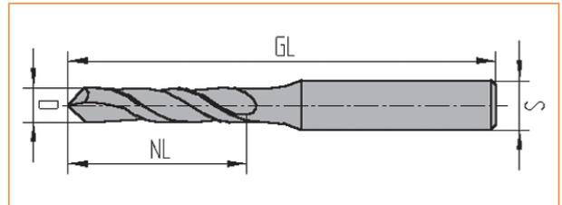
zum Fräsen und Bohren von Kunststoffprofilen auf Bearbeitungszentren z. B. AFS-Schirmer • elumatec • Haffner • Rapid
