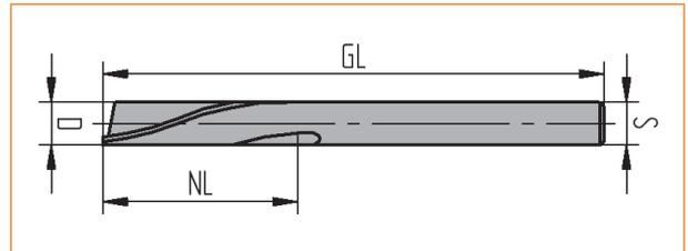
zum Fräsen von Profilen aus Aluminium, Kunststoff etc. auf Kopierfräsmaschinen z. B. elumatec • Haffner • Rapid • Rotox • Striffler • Wegoma
