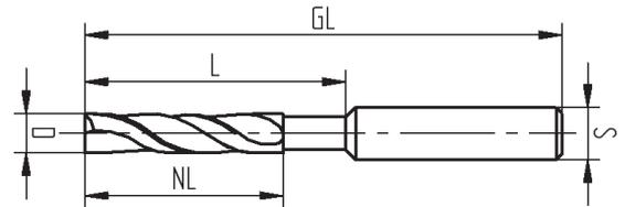
zum Fräsen und Bohren von Profilen aus Aluminium, Kunststoff etc. auf Kopierfräsen z. B. elumatec KF 178
